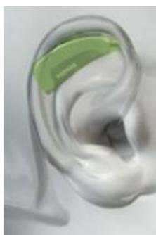
La prothèse auditive contour d'oreille contient un boîtier externe qui renferme toute l'électronique de l'appareil. La taille de cette partie varie fonction de la puissance du modèle.
