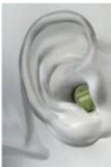
La coque est réalisée sur mesure, grâce à une empreinte de votre oreille réalisée par votre audioprothésiste. Toute l'électronique se trouve à l'intérieur de la coque.
