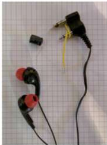
Casque avec condensateur soudé destiné à supprimer la composante continue en sortie de circuit
